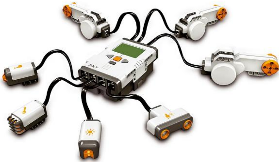
Obrázek 11 – Řídicí jednotka LEGO Mindstorms NXT s motorky a senzory
