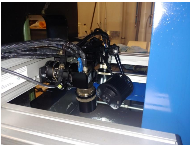
Obr. 3.5 Detailní záběr nainstalovaného optického systému nad zkušebním vzorkem, v dolní části se nachází ochranné sklo
