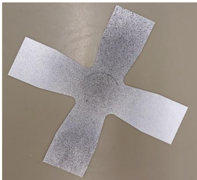
Obr. 3.14 Zkušební vzorek pro biaxiální namáhání rovinného kříže s naneseným bílo-černým patternem
