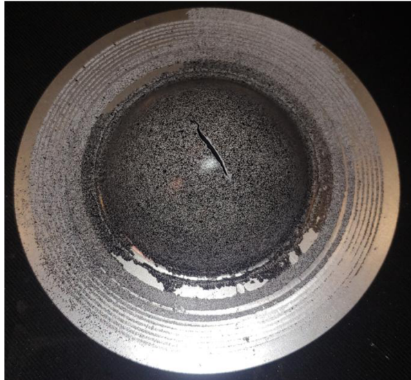
Obr. 3.7 Zkušební vzorek po konci bulge testu
