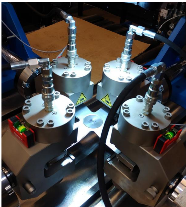
Obr. 3.16 Detail umístění zkušební vzorku mezi čelistmi zkušebního zařízení (pozn. před nanesením deformační sítě).
