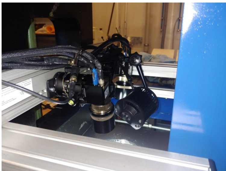
Obr. 3.5 Detailní záběr nainstalovaného optického systému nad zkušebním vzorkem, v dolní části se nachází ochranné sklo
