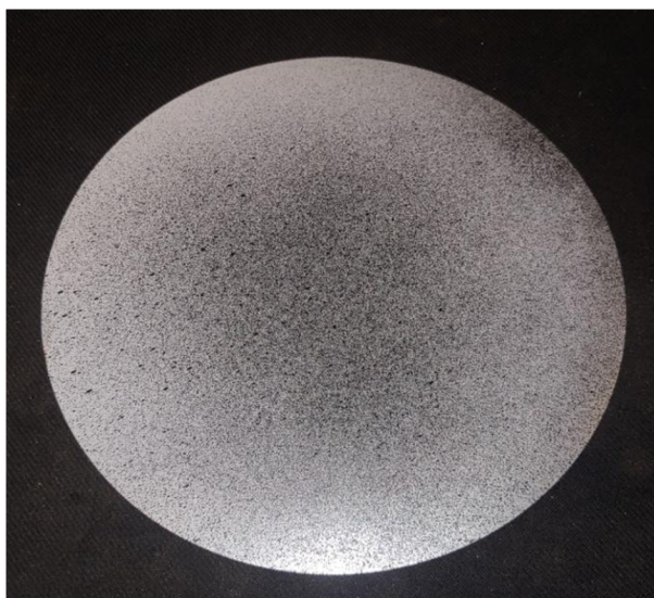
Obr. 3.4 Zkušební vzorek v podobě kruhovitého plechu s naneseným bílo-černým patternem před bulge testem
