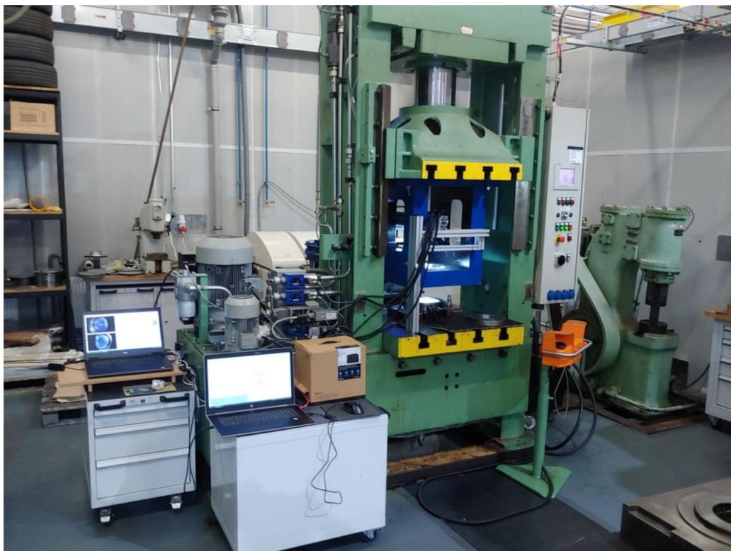
Obr. 3.6 Hydraulický lis CBA 300/63 s připojeným optickým systémem a připevněným zkušebním vzorkem. Bližší notebook ovládal hydraulický agregát a posílal data o tlaku do vzdálenějšího notebooku, který snímal skrze optický systém deformace a vyhodnocoval průběh zkoušky.
