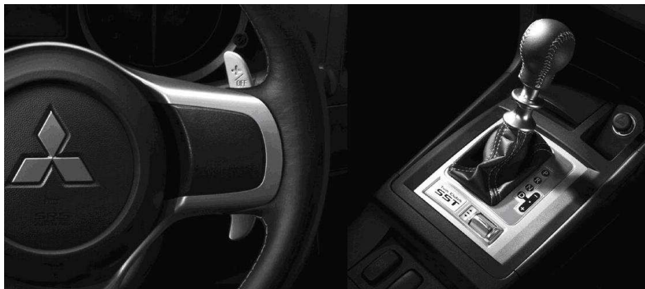
Obr. 7.11 Ukázka způsobů řazení převodovky SST [ 16 ]
