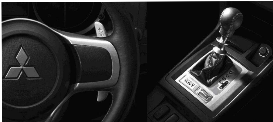
Obr. 7.11 Ukázka způsobů řazení převodovky SST [ 16 ]
