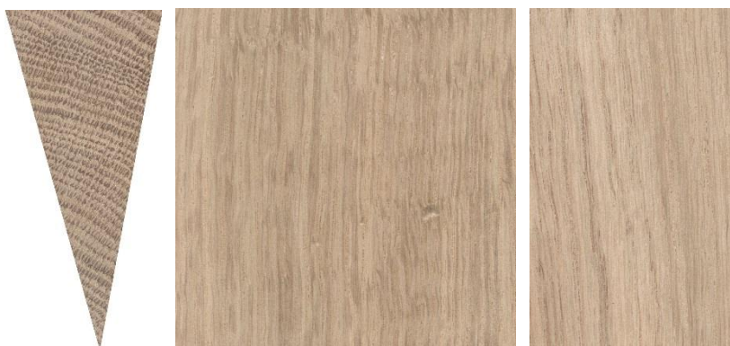
Obrázek 17 Transverzální, radiální a tangenciální řez dubu ( wood.mendelu.cz ).
