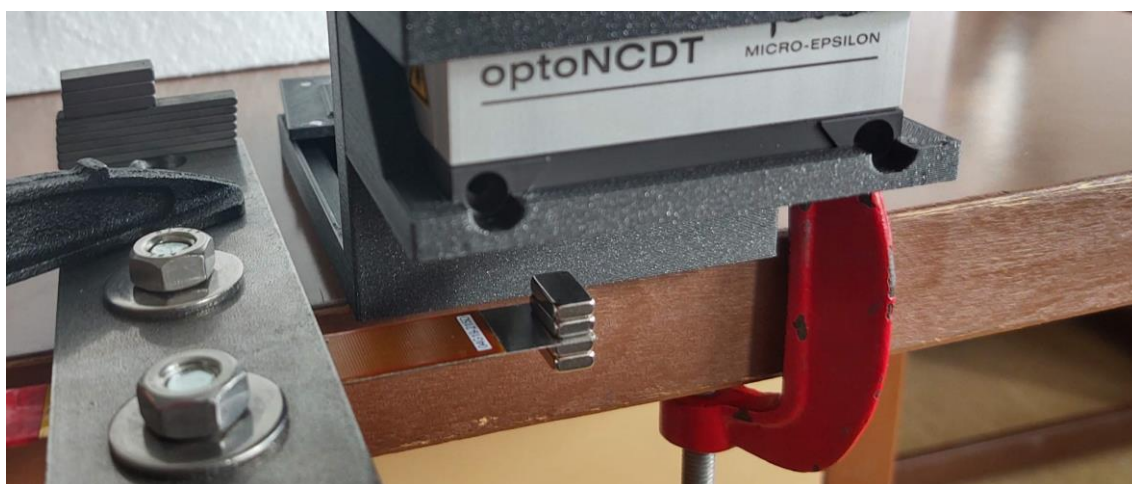
Obr. 51 Piezoelektrický mikro sběrač vlastní konstrukce při měření
