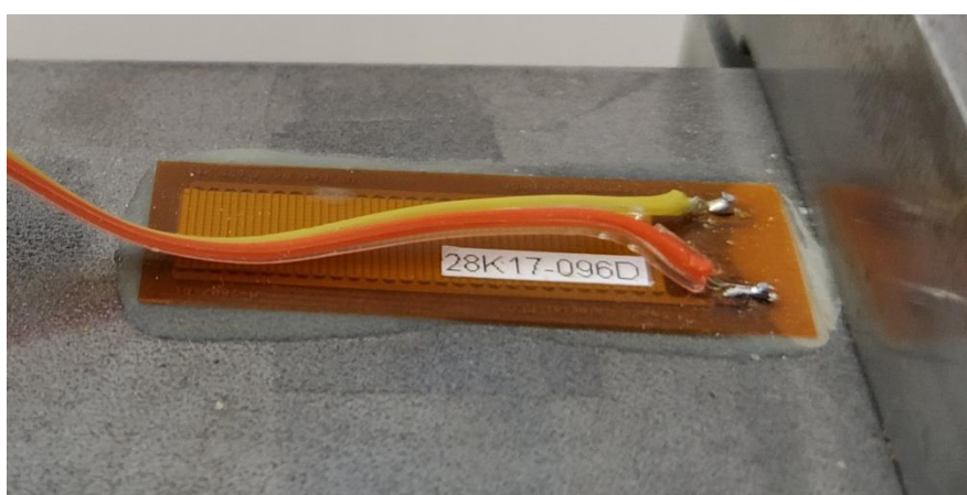
Obr. 76 Piezoelektrická snímací vrstva na vibrujícím nosníku
