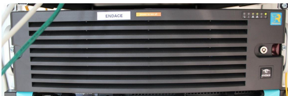
Obr. 2.1: Síťový analyzátor EndaceProbe 7000 v laboratoři SIX
