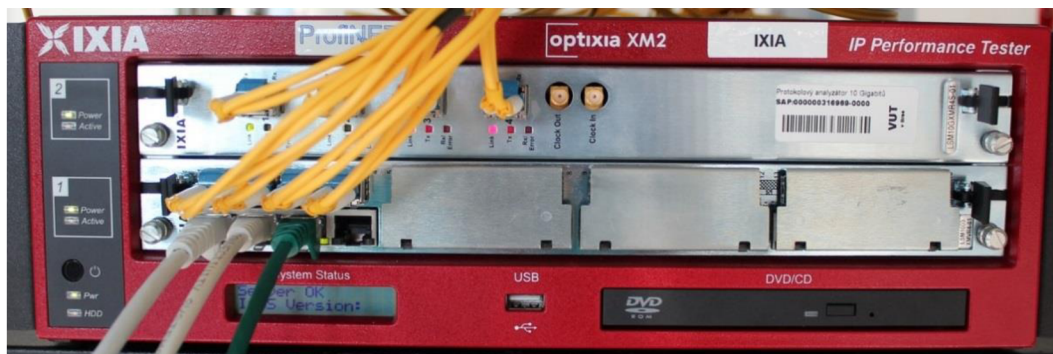
Obr. 3.4: Generátor provozu IXIA XM2 v laboratoři SIX
