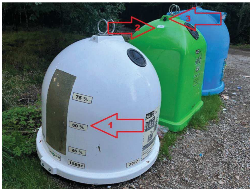
Obrázek 18 - Kontejnery ve městě Rokycany, šipka č.1: stupnice zaplněnosti, šipka č.2: čárový kód s identifikačními údaji kontejneru, šipka č.3: RFID čip
