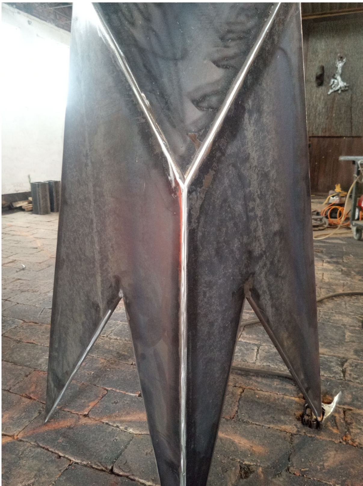
Obr. 7: Hotové sváry byly nakonec vybroušeny.
