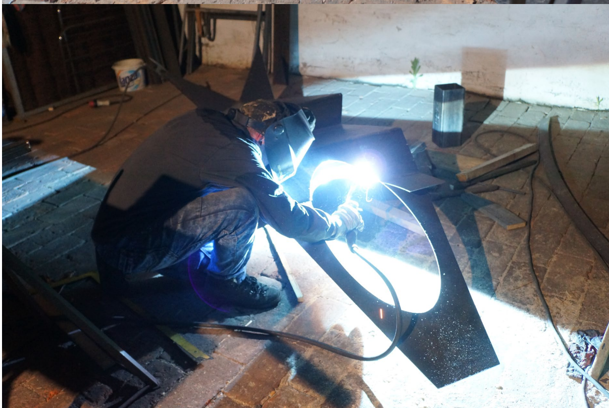
Obr. 2: Díly byly následně přibodovány obloukovou svářečkou.
