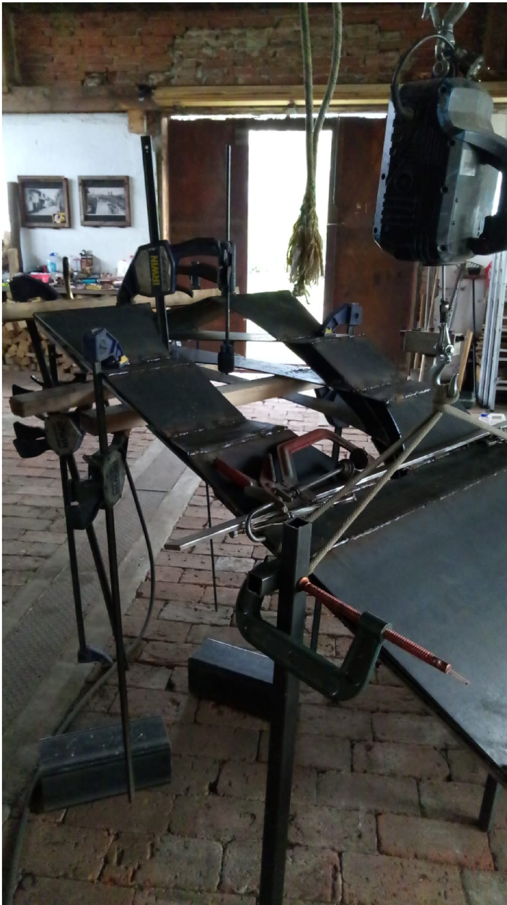
Obr. 6: Následoval proces postupného vyplnění spár mezi body samotnými sváry.
