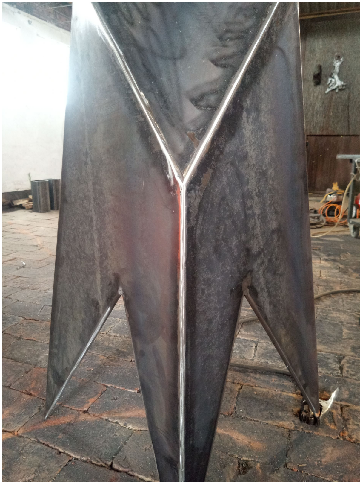
Obr. 7: Hotové sváry byly nakonec vybroušeny.
