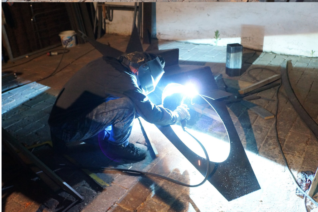
Obr. 2: Díly byly následně přibodovány obloukovou svářečkou.
