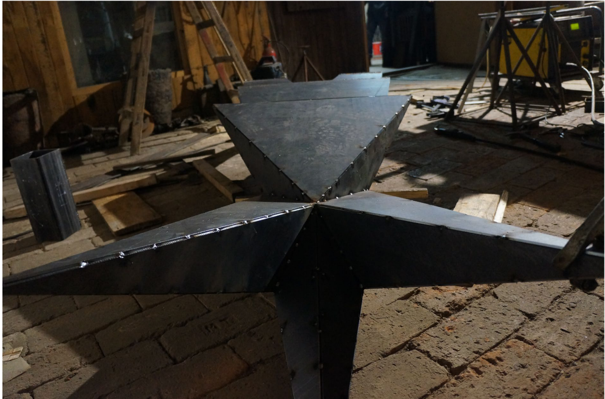
Obr. 4: Jednotlivé body byly přivařeny po obvodu styčných ploch v rovnoměrných intervalech.
