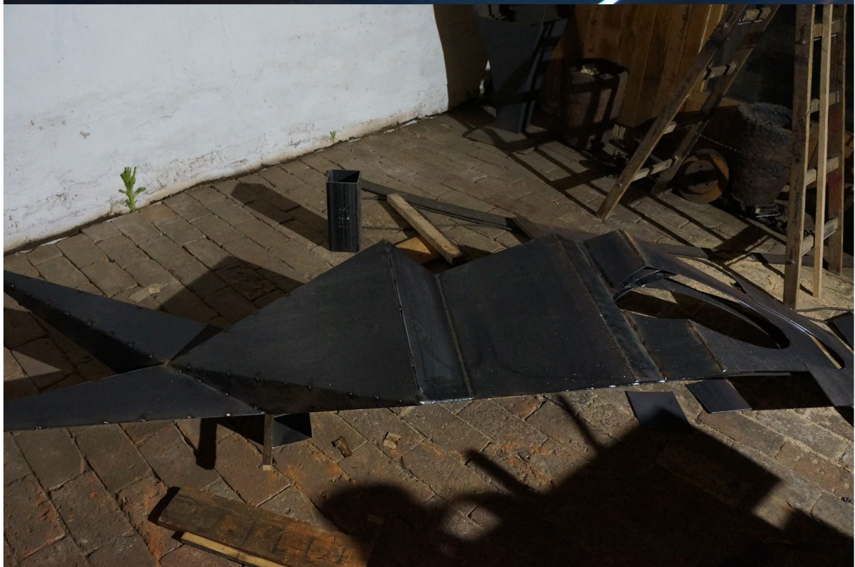
Obr. 3: Obtížné bylo udržet souměrnost a směry, neboť práce probíhala v horizontální poloze.
