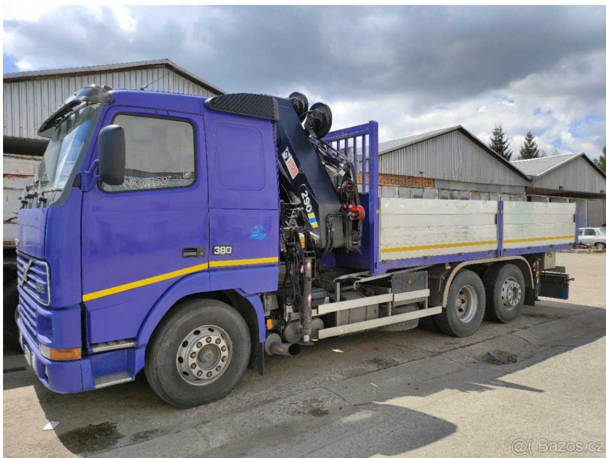
Obrázek 62 Automobil Volvo FH12 380 s hydraulickou rukou AMCO VEBA 918NG 4S. [86]
