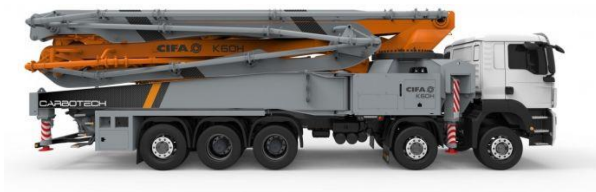
Obrázek 58 Mobilní čerpadlo betonu CIFA K60H [81]
