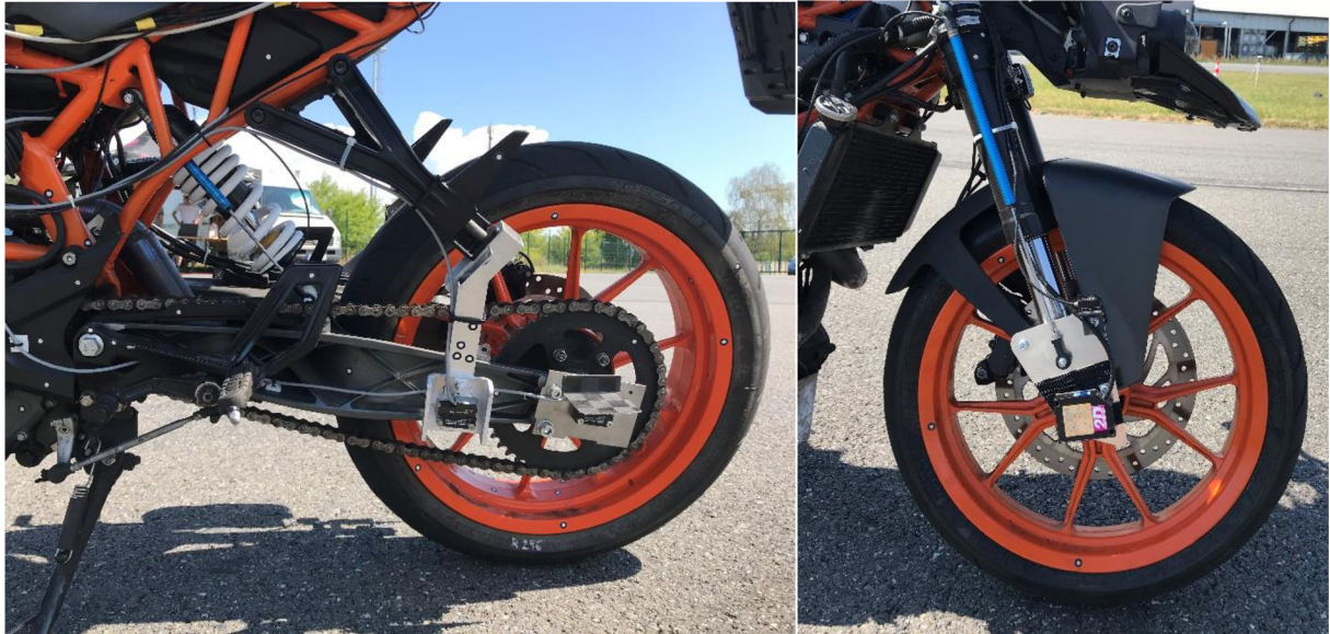
Obr. 3.4 Umístění potenciometrů a optických snímačů vzdálenosti
