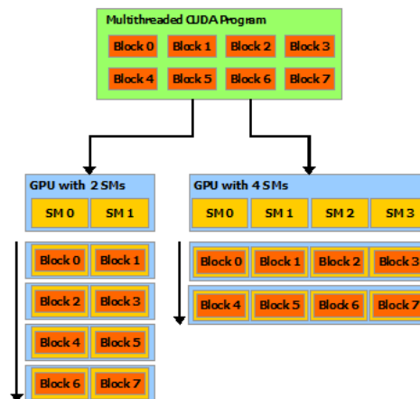
Obrázok 3.4: Plánovanie výpočtu [29]. Ukážka zobrazuje škálovateľnosť výpočtu s množstvom dostupných SM ( Streaming Multiprocessor ). Program je rozdelený do blokov vlákien, vykonávaných nezávisle. Použitím GPU s väčším počtom SM je možné skrátiť dobu výpočtu.
