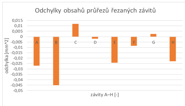
Obr. 75 Odchylka obsahů průřezů řezaných závitů A–H.
