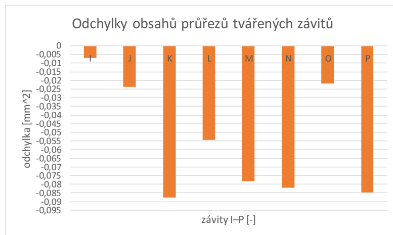
Obr. 76 Odchylka obsahů průřezů tvářených závitů I–P.
