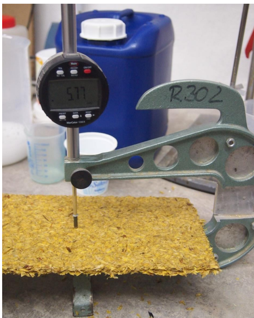
Příloha 8 Přesná kontrola tloušťky desky po vylisování pomocí úchylkoměru (deska z plev pšenice ozimé)
