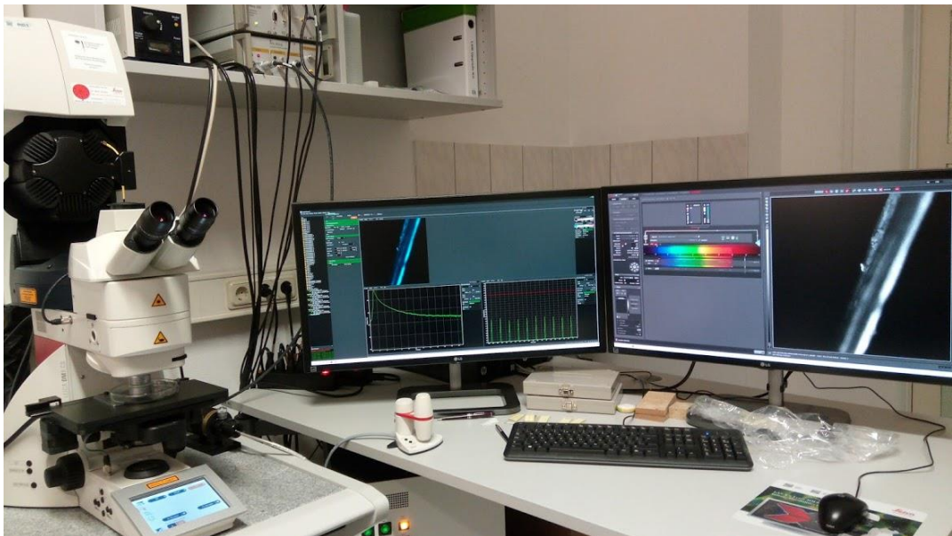
Příloha 12 Sestava laserového konfokálního mikroskopu pro fluorescenční časovou zobrazovací mikroskopii
