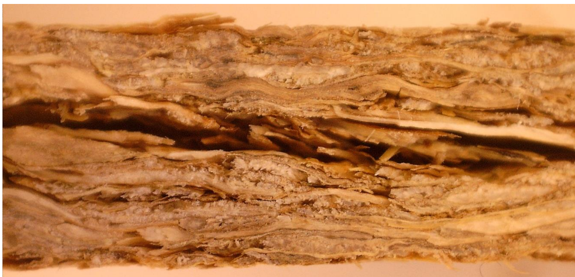
Příloha 9 Pohled na příčný řez desky ze slámy pšenice ozimé – deska s trhlinou
