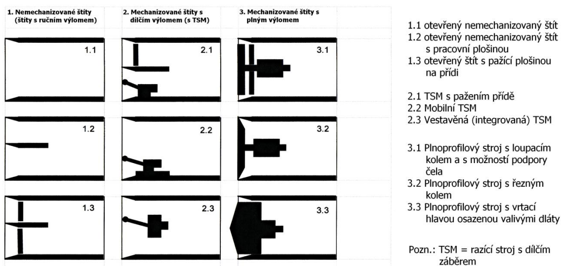
Obr. 5.11 Systémy štítů podle způsobu výlomu resp. zajištění profilu [8]
