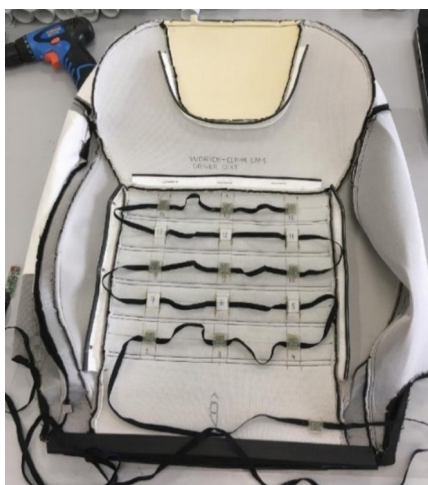
Obrázek 9 - Senzory umístěné pod potahovou vrstvou autosedačky [27]
