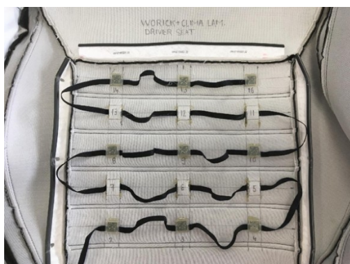
Obrázek 10 - Senzory umístěné pod potahovou vrstvou autosedačky [27]
