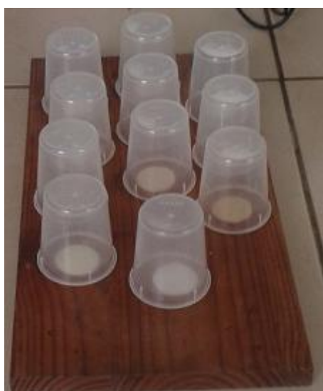
Obr. 10 Zkouška odolnosti proti studeným kapalinám (Luňáček – vlastní foto 2015).
