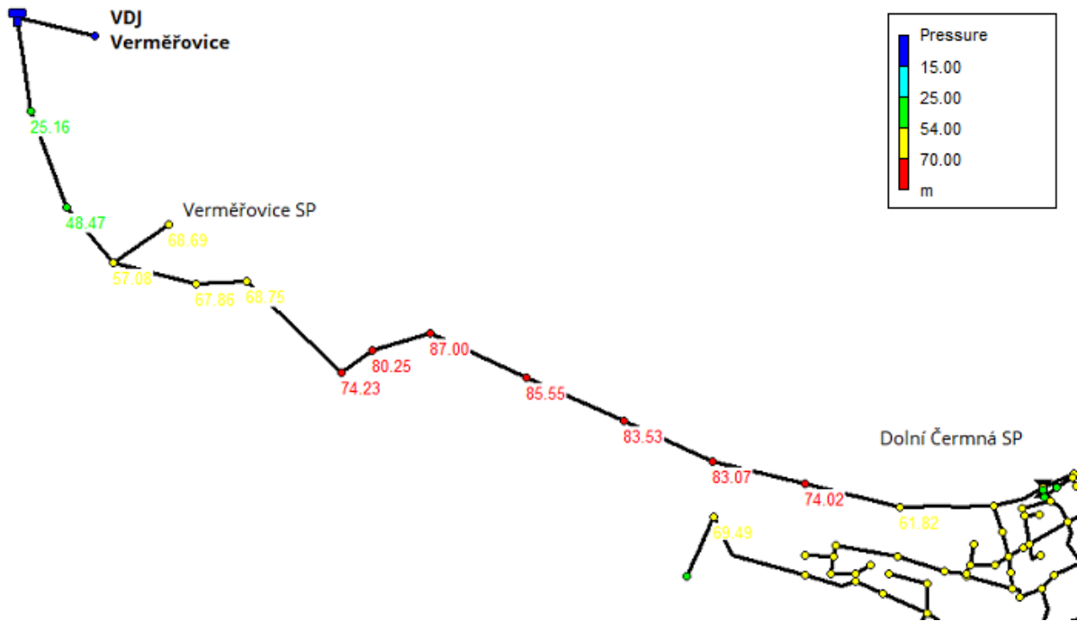
Obr. 4.9 Hydraulická analýza: tlakové poměry VDJ Verměřovice - Dolní Čermná
