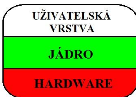
Obrázek 1: Vrstvy abstrakce v architektuře OS
