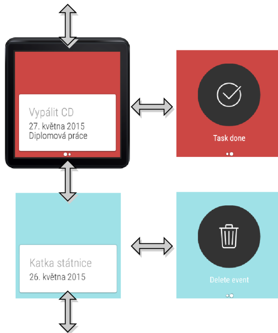
Obrázek 5.7: Android Wear aplikace. Data jsou prezentovány ve 2D mřížce. Vertikálním pohybem přepínáme mezi řádky, horizontálním pohybem přecházíme mezi kartou s daty a akcemi.
