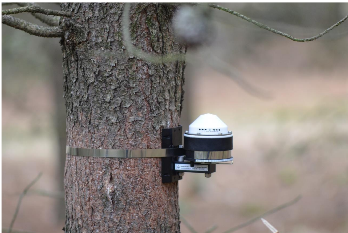
Obrázek 2: Instalovaný dendrometr DRL26A na borovici pokroucené
