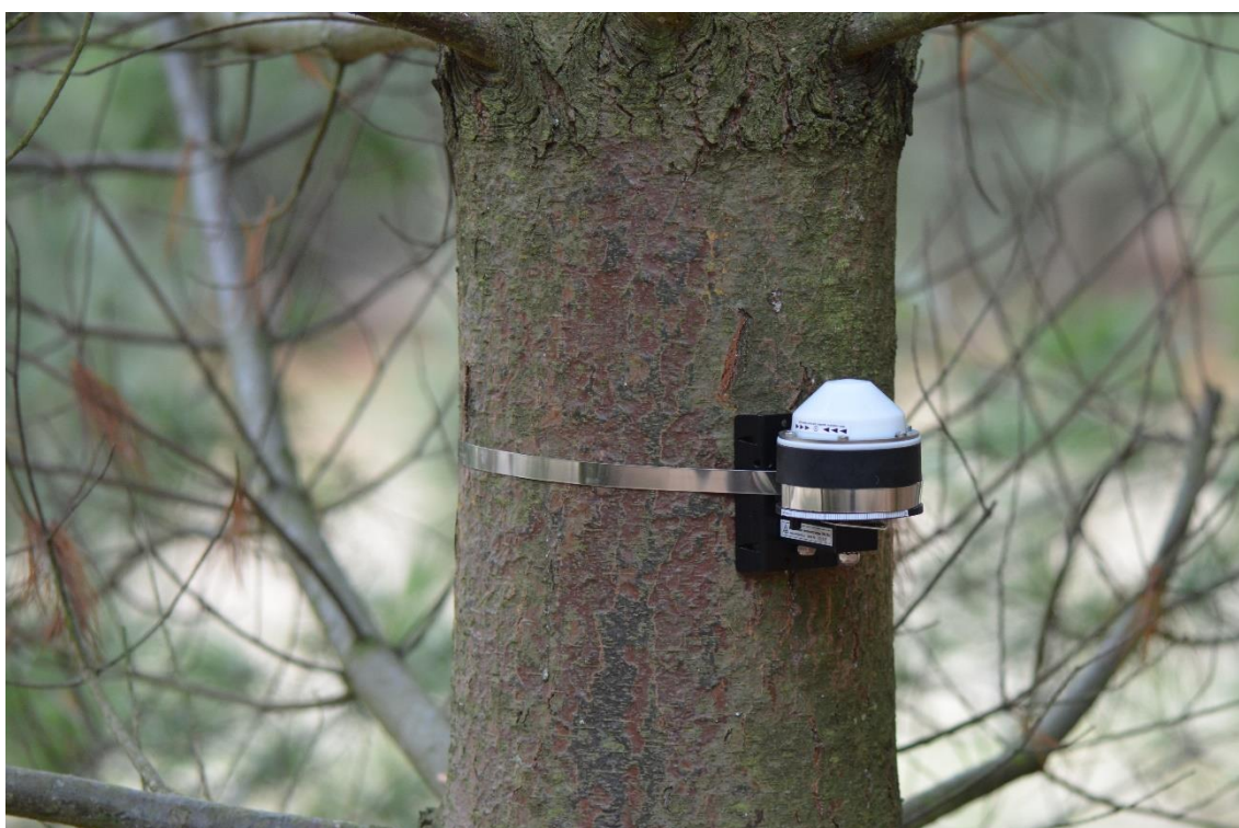
Obrázek 3: Instalovaný dendrometr DRL26A na borovici vejmutovce
