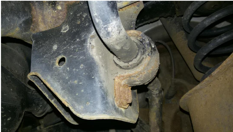
Obr. 13 Opotřeбенý silentblok stabilizátoru
