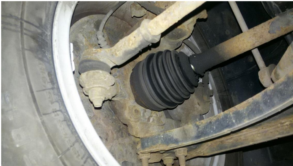
Obr. 14 Vadná manžeta homokinetického kloubu
