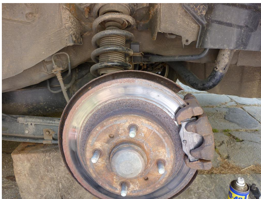
Obr. 4 Nerovnoměrně opotřebený kotouč
