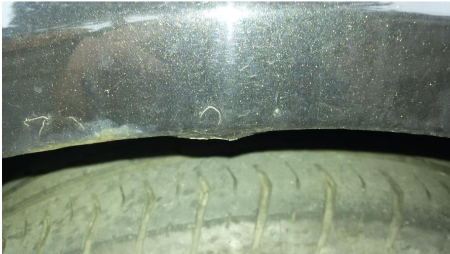
Obr. 17 Koroze předního blatníku
