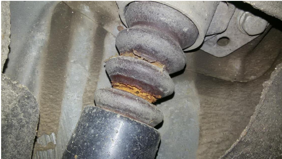
Obr. 9 Vadný doraz tlumiče
