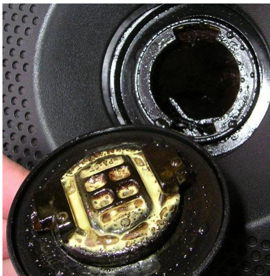
Obr. 8 Voda v oleji
