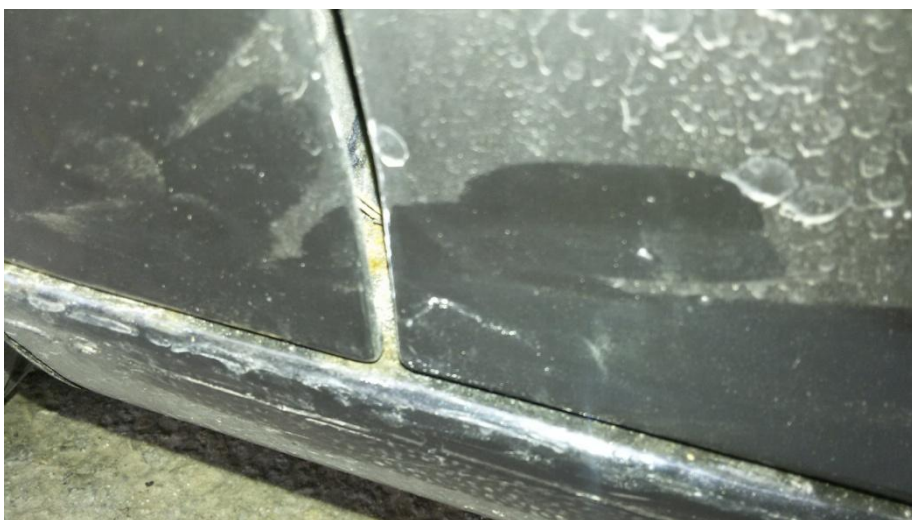
Obr. 19 Neodborná oprava dveří
