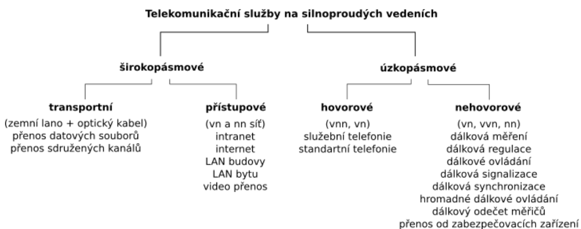
Obr. 2.1: Pohled na možné rozdělení telekomunikačních služeb na silnoproudých vedeních [3]
