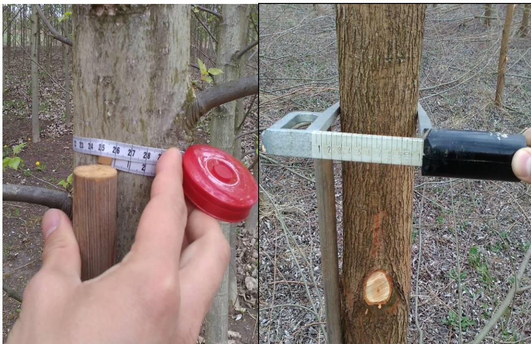
Obr. 12: Ukázka měření porostu (vlevo měření obvodu, vpravo měření průměru za pomoci lesnické průměrky)
