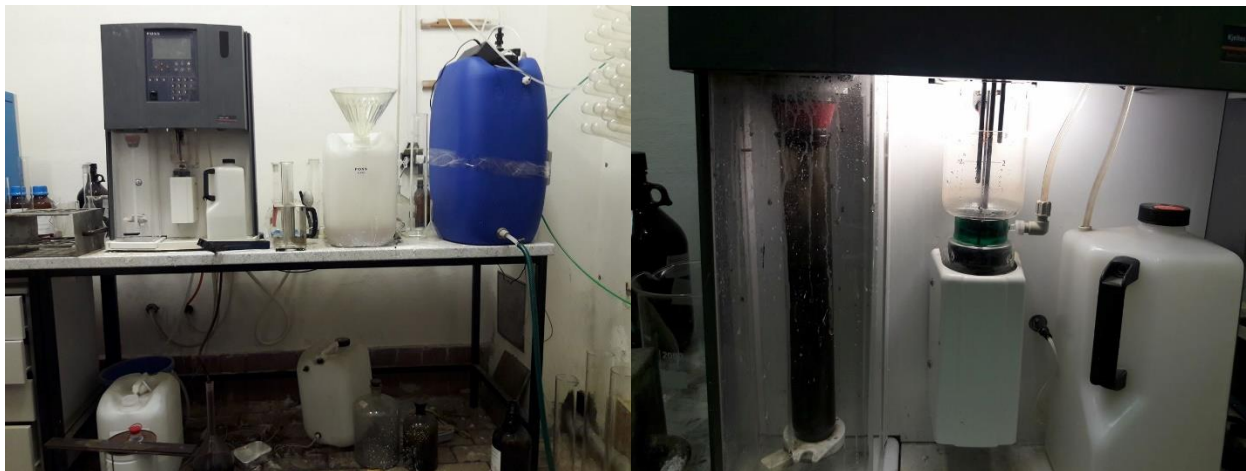
Obrázek č. 8.: Destilační jednotka i s detailem
