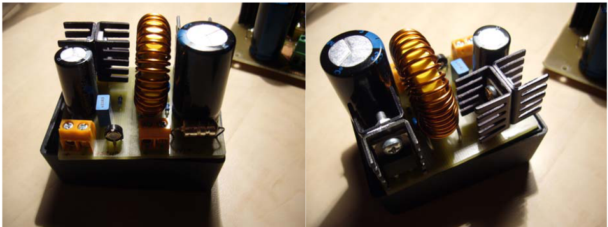
Obr. 35 - hotový měnič s LM2587
