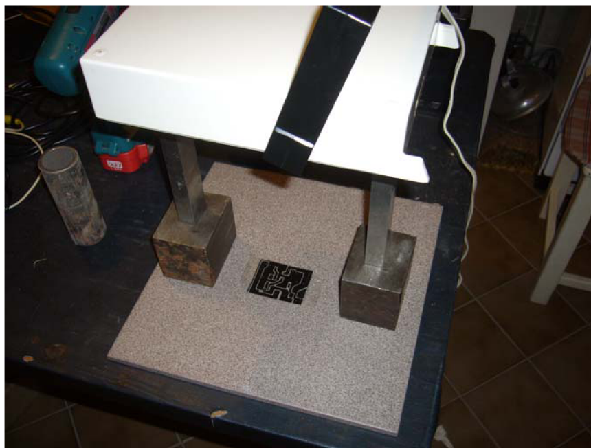
Obr. 32 – Vzdálenost výbojky od DPS a fólie
