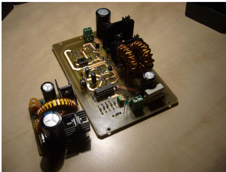
Obr. 40 – Měnič s SG3524 vpravo, s LM2577 vlevo
