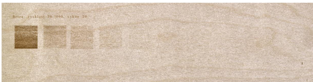
Obrázek 23 Výkon 20 W a rychlost gravírování od 50 mm.s -1 do 250 mm.s -1
