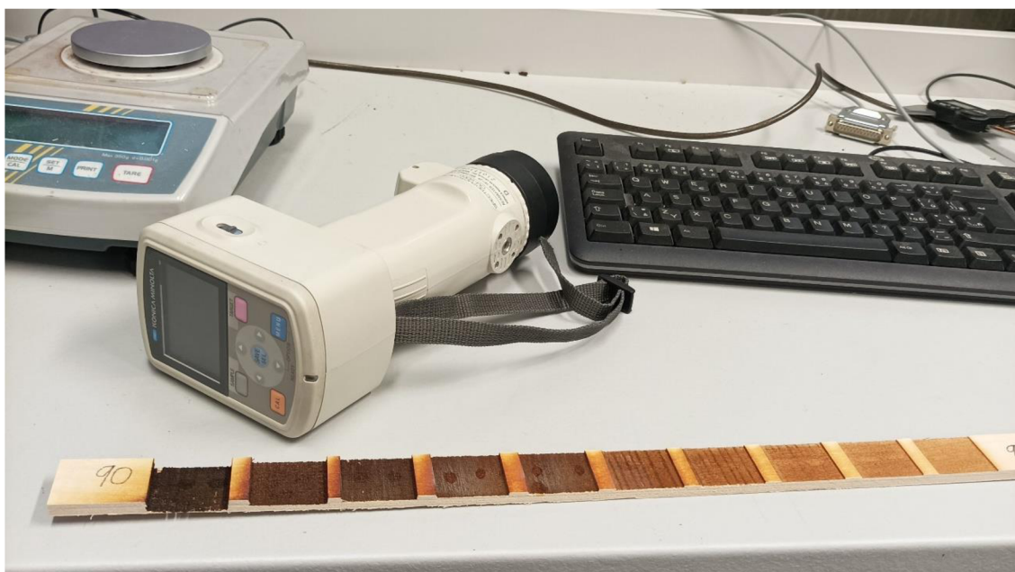
Obrázek 25 Měření barvy spektrofotometrem Konica Minolta CM-600d
