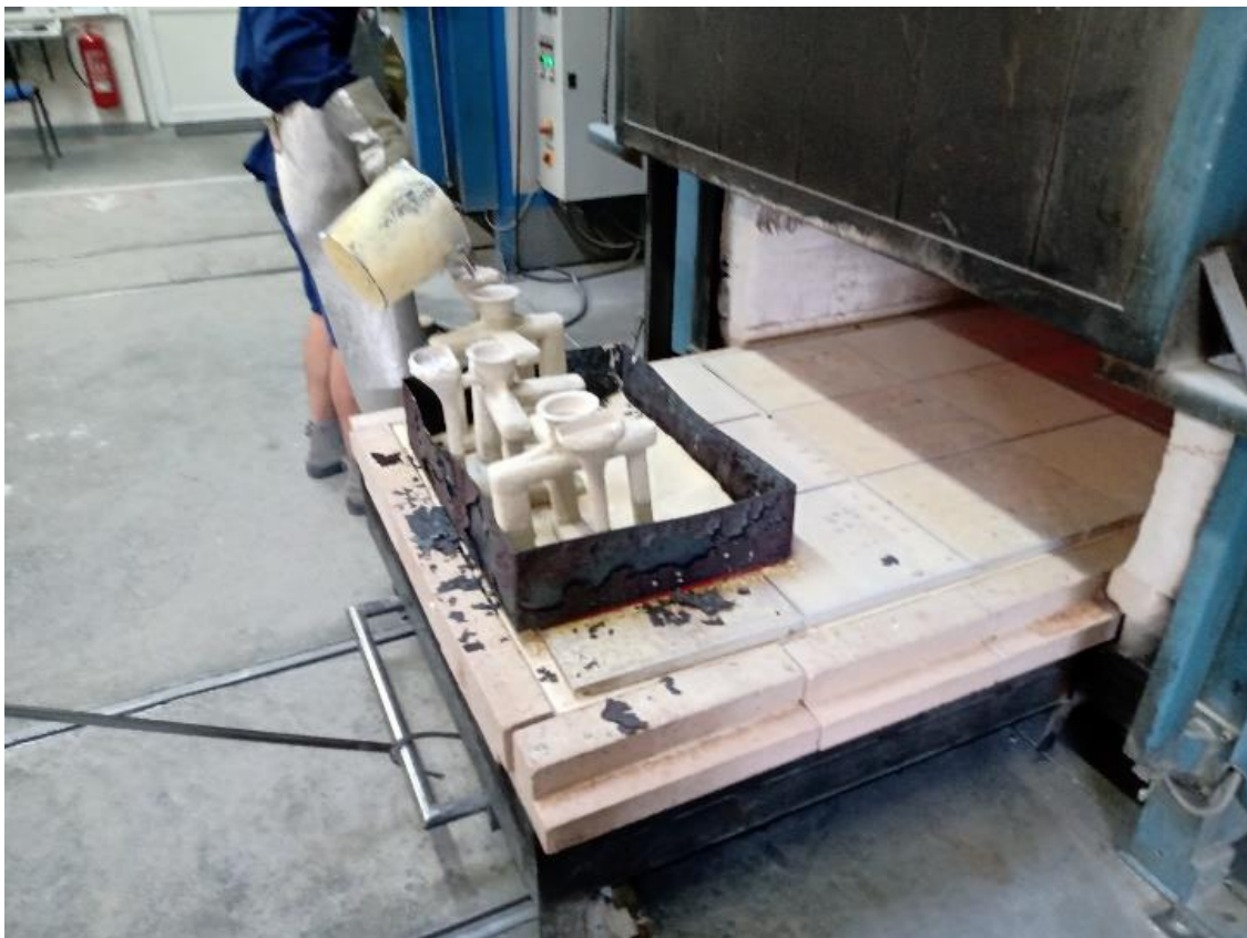
Obr. 22 - Odlévání zkušebních odlitků.
