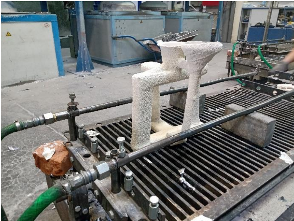
Obr. 24 - Ochlazování pomocí ofukování tlakovým vzduchem.
