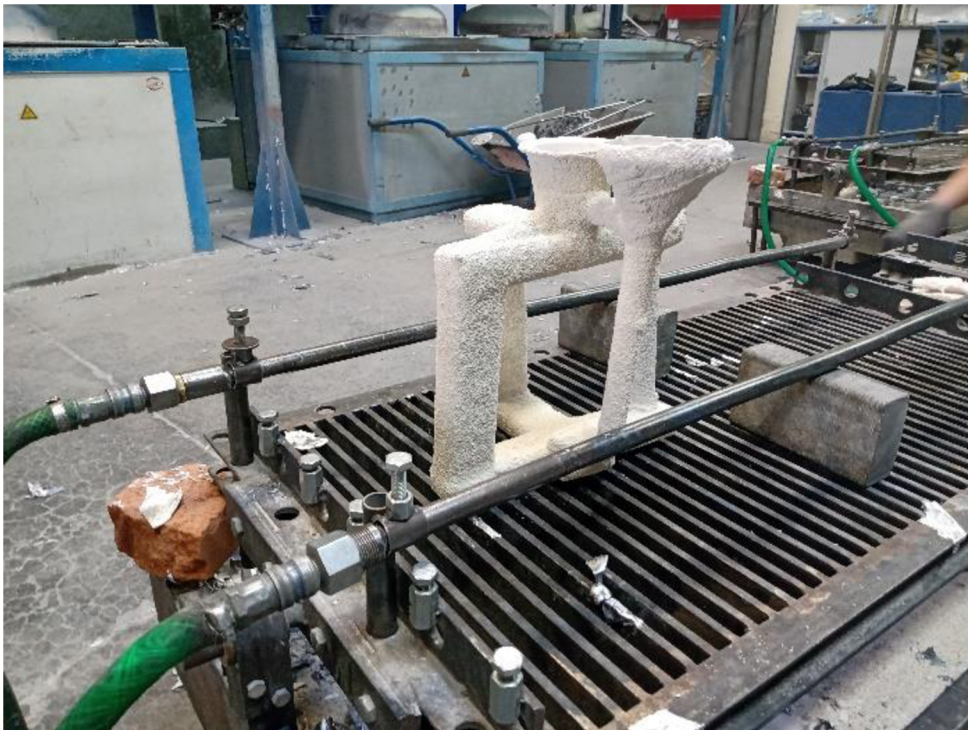
Obr. 24 - Ochlazování pomocí ofukování tlakovým vzduchem.
