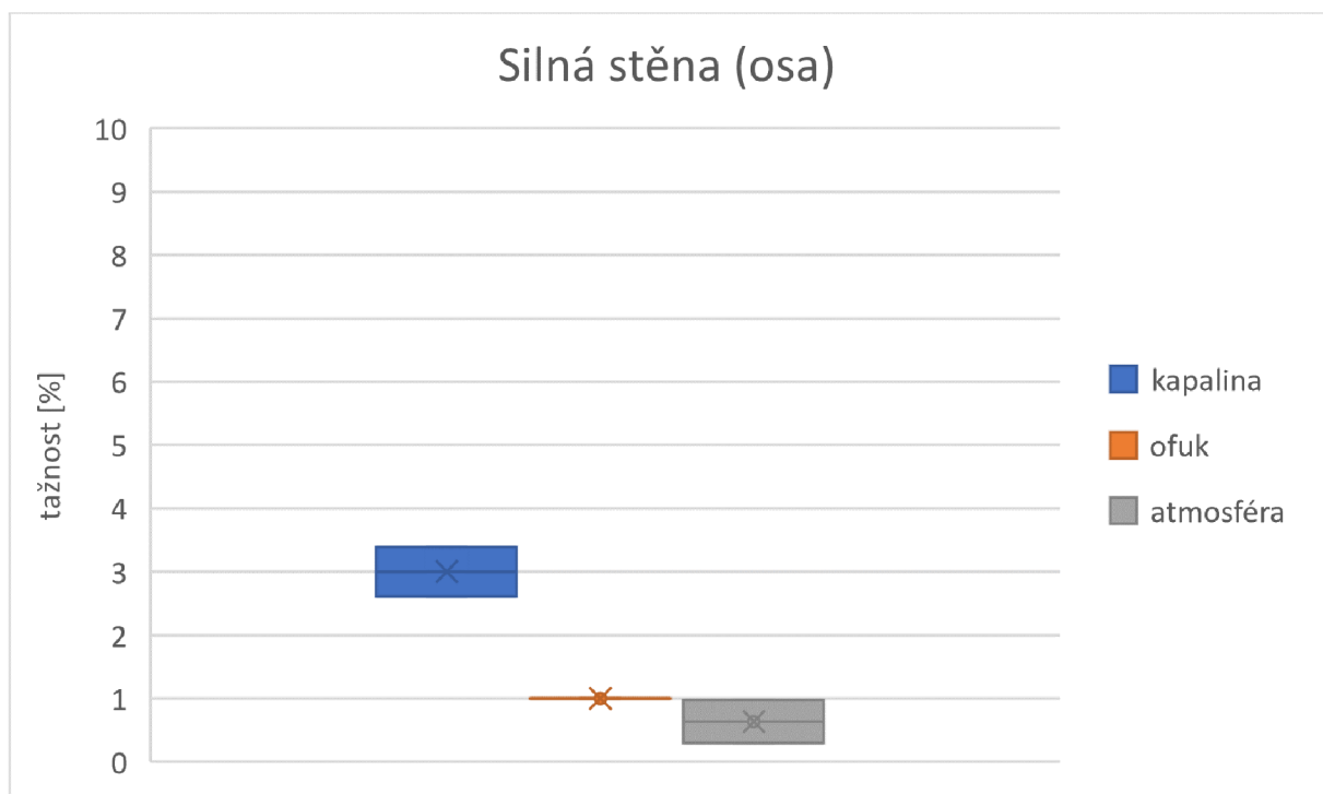
Obr. 43 – srovnání vlivu režimu ochlazování na tažnost – silná stěna (osa).
