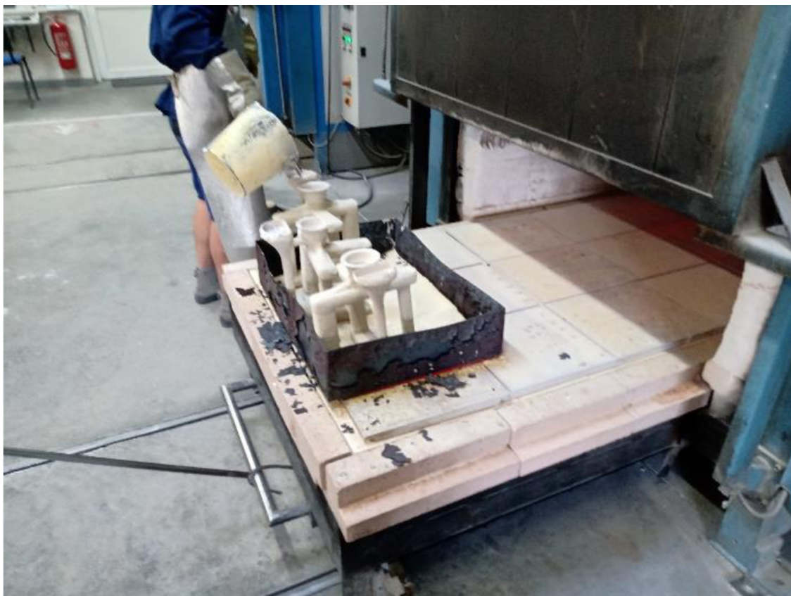
Obr. 22 - Odlévání zkušebních odlitků.
