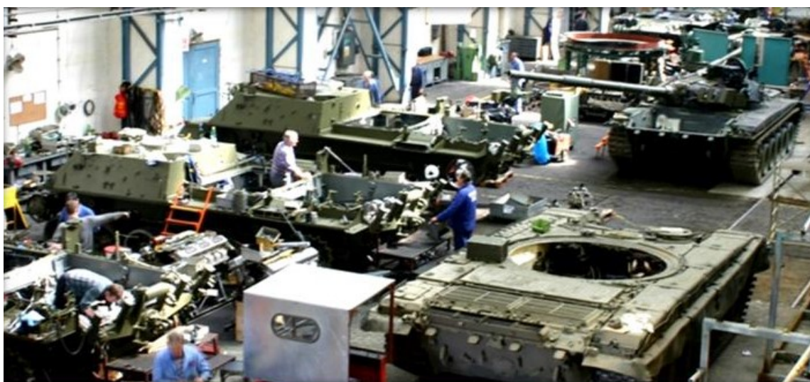
Obr. 2.4 Demontáž tanku T-72
