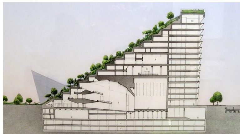
Obrázek 6: Řez budovou Acros Fukuoka se střešní zelení (zdroj: http://carlostarsitano.blogspot.cz/2012/01/la-arquitectura-como-fabula-los-mundos.html )
