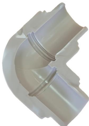
Obr. 1.8: Homogenita polyfúzního spoje [12]
