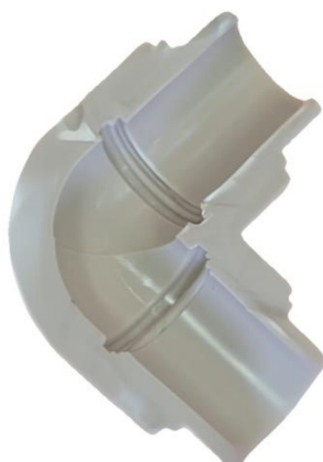
Obr. 1.8: Homogenita polyfúzního spoje [12]
