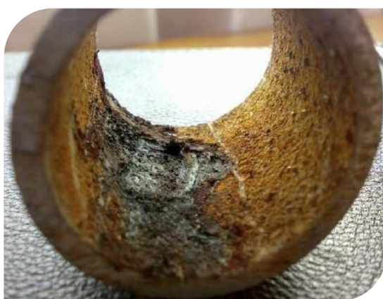
Obr. 1.3: Koroze ocelového potrubí [6]
