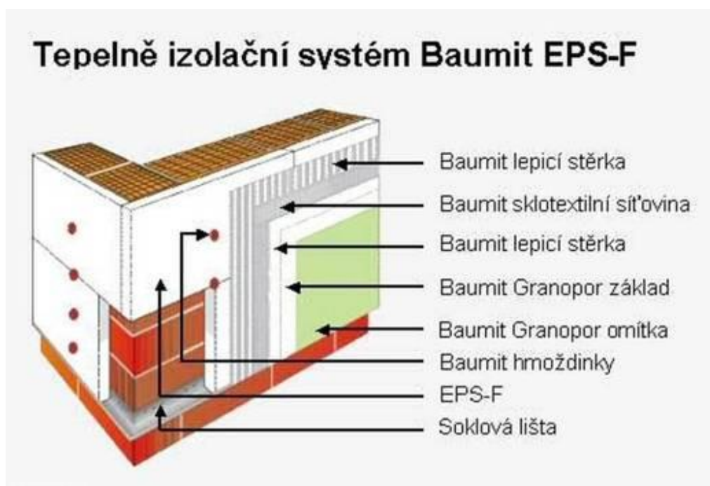
Obr. 5 Tradiční skladba tepelně izolačního systému Baumit EPS-F
