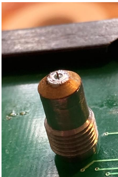
Obrázok 35 Upravený konektor s pripevnenou rozšírenou zemou
