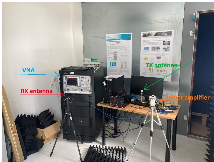
Obrázok 57 Experimentálne pracovisko s odtieneným odrazom od zeme
