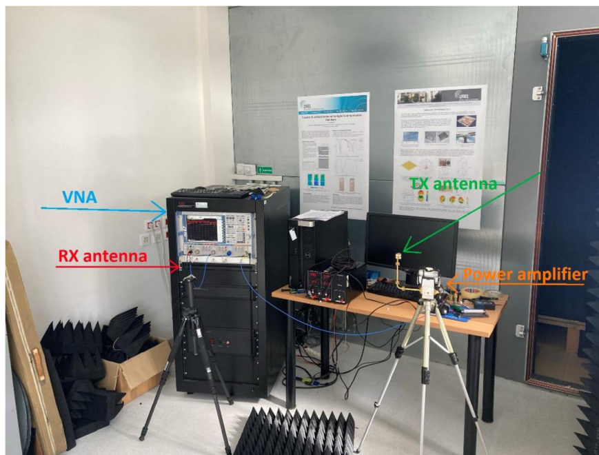
Obrázok 57 Experimentálne pracovisko s odtieneným odrazom od zeme
