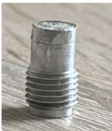
Obrázok 34 Konektor s úpravou (odstránené bočné úchyty)
