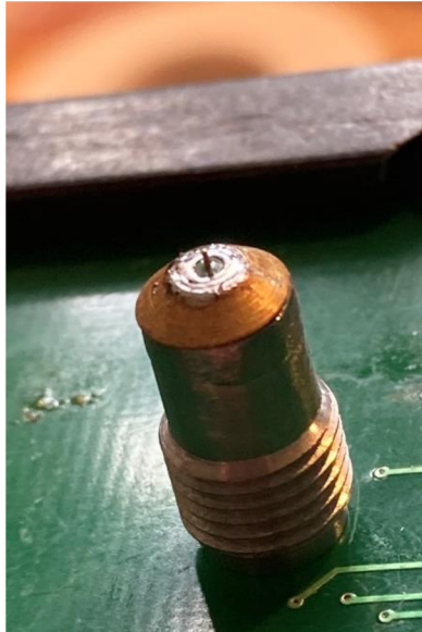
Obrázok 35 Upravený konektor s pripevnenou rozšírenou zemou
