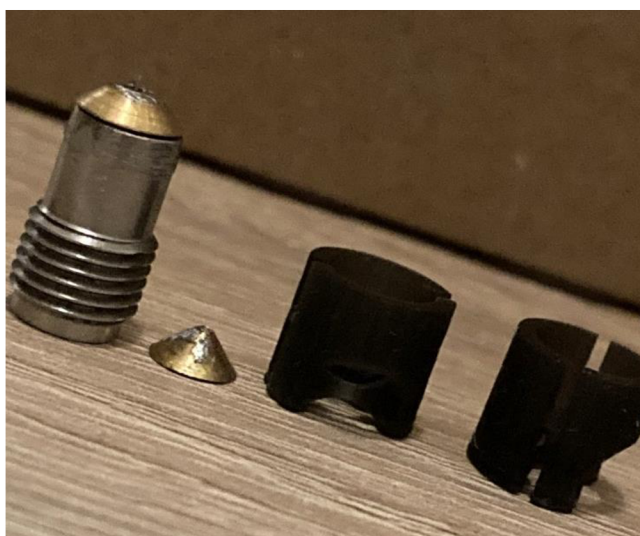
Obrázok 37 Oddelené části antény a pájecí forma
