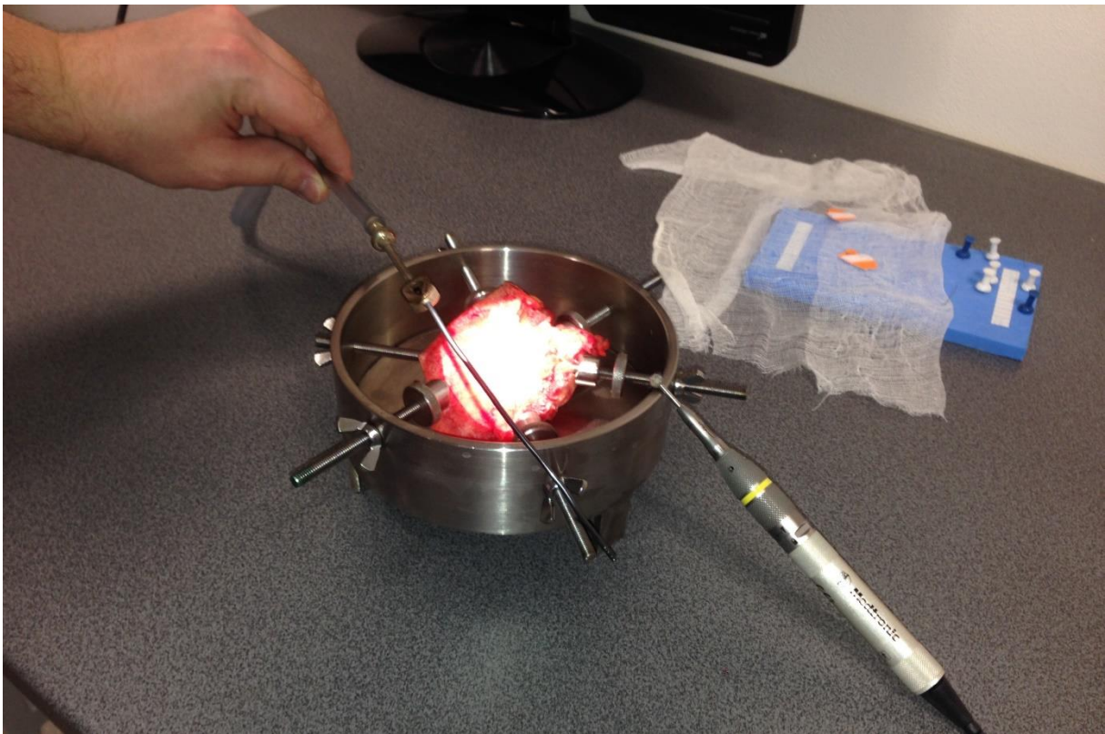
Obrázek 5. Fixátor s uchycenou spánkovou kostí při práci s frézou (zdroj: autor)
