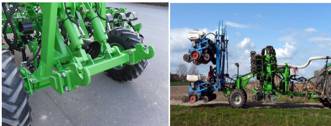
Obr. 5 Spojení stroje Duro France Strip-Till se secím strojem (www.duro-france.com)
