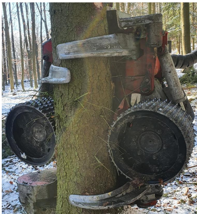
Obrázek 2.6: Kácecí nože a podávací válce během kácení
