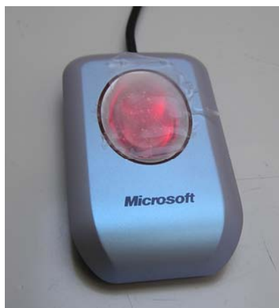
Obr.37. Ukázka přiloženého odlitku na senzor.
