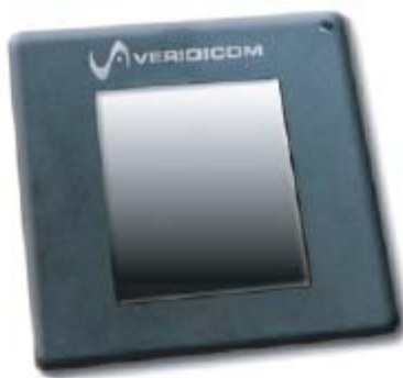
Obr. 15 : Ukázka kapacitního snímače firmy Veridicom Internacional.
