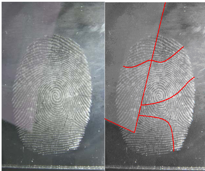
Obr.22. Levá část obrázku zachycuje obrazec s nevhodnými reflexy, pravá část následně elementy zpracovávané samostatně.
