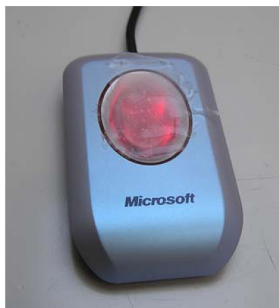
Obr.37. Ukázka přiloženého odlitku na senzor.
