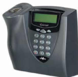
Obr. 39. Snímač od firmy Bioscrypt V-Station ( kapacitní snímač).
