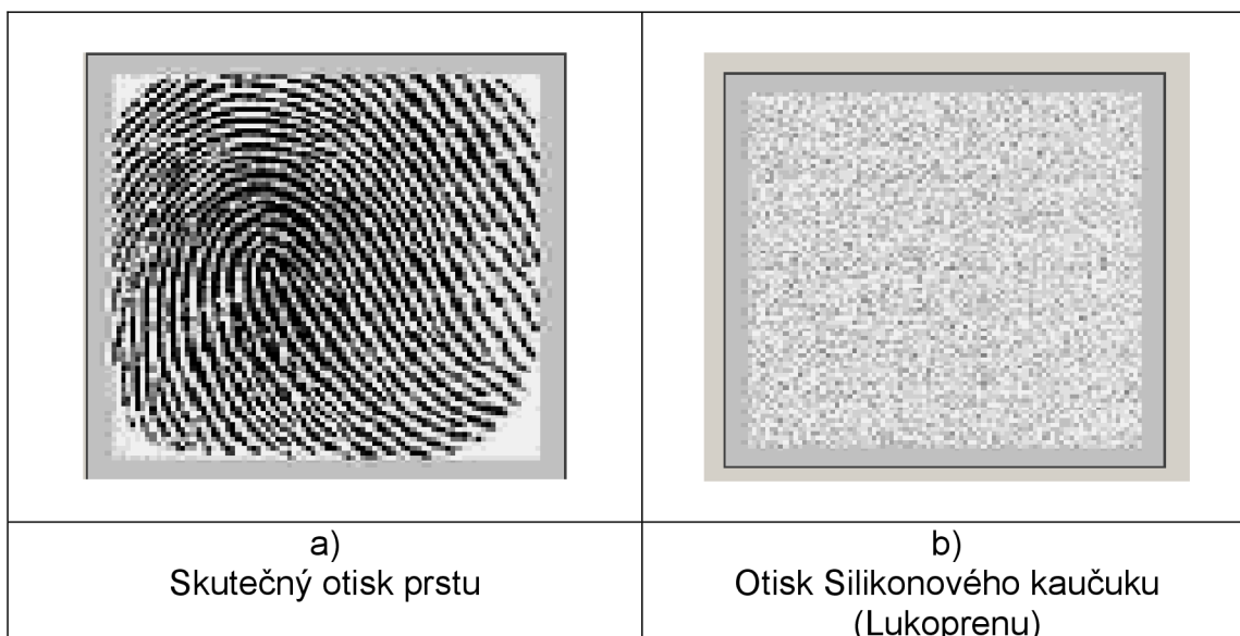
Obr. 38. Porovnání sejmutého obrazce snímačem V Station.
