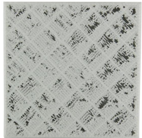
Obrázek 58– Nedostatečné množství vytlačeného plastu – zdroj: Ultimaker [46]
