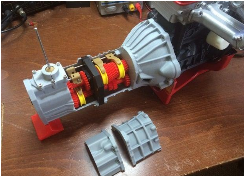
Obrázek 28 – Příklad vytisknuté 5rychlostní převodovky – zdroj: ericthepoolboy [26]
