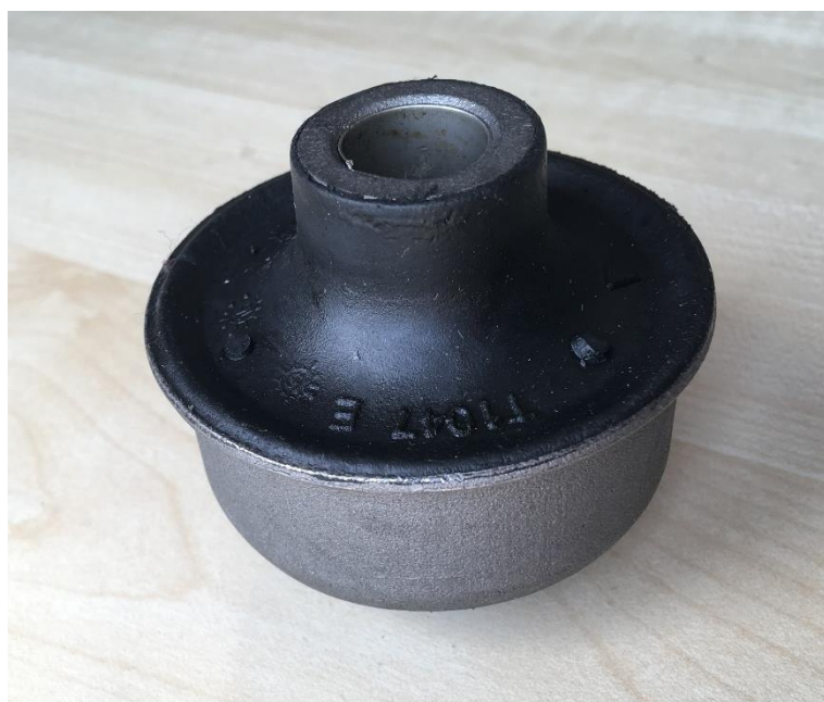
Obrázek 31 – Gumové uložení nápravy osobního automobilu – zdroj autor
