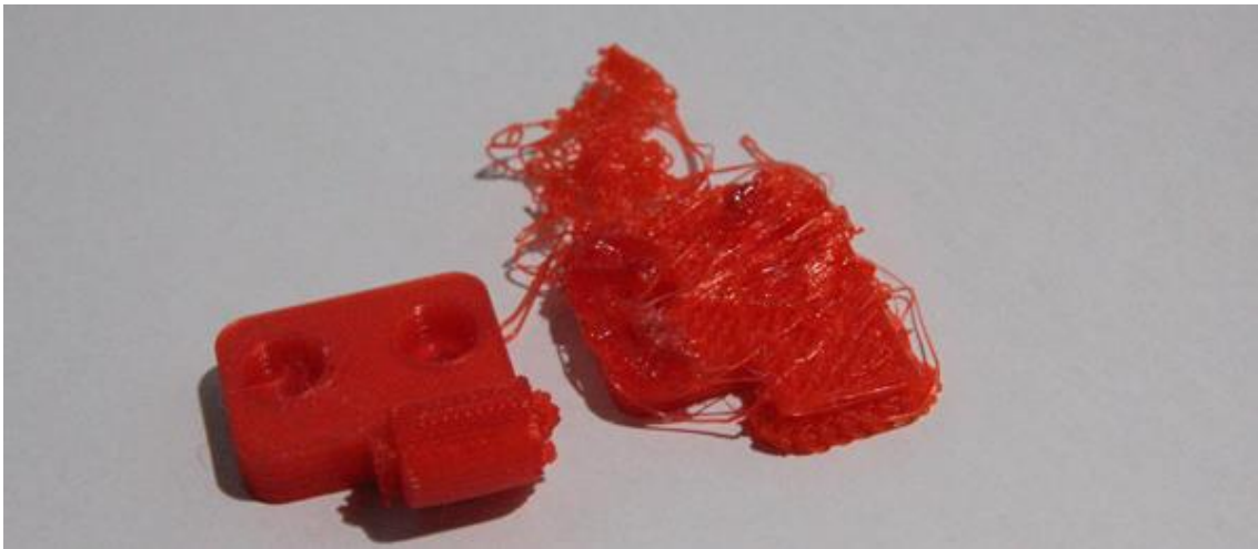
Obrázek 48 – Příklad uvolněného předmětu v průběhu tisku – zdroj: MODFAB [36]
