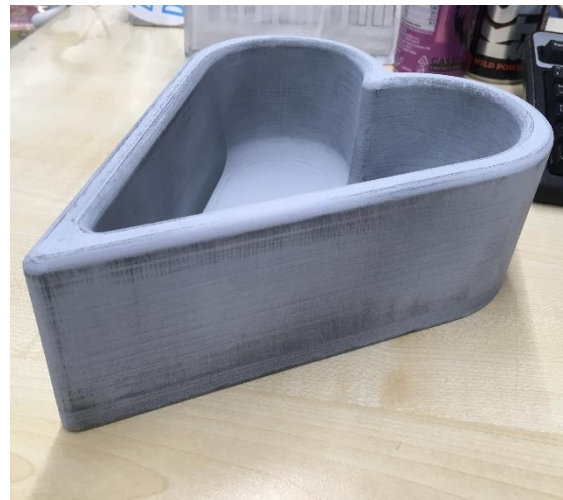
Obrázek 46 – Příklad předmětu po zabroušení a vyplnění plnidlem – zdroj: autor
