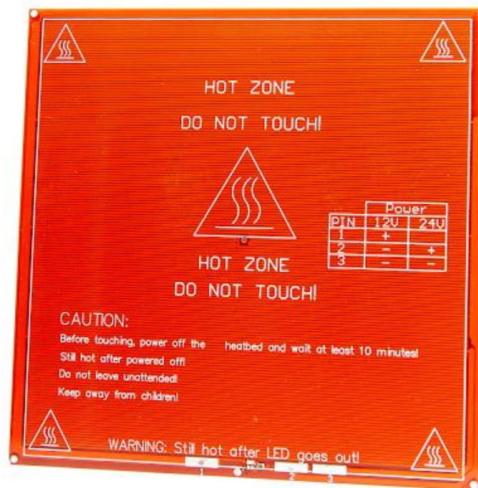
Obrázek 7 – Vyhřívání tisková plocha – zdroj: MatterHackers [7]
