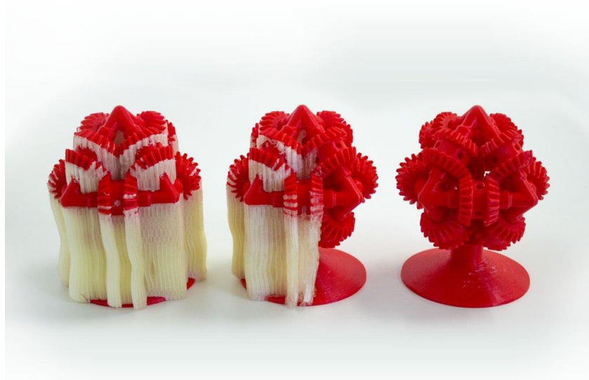
Obrázek 14 – Podpěry vytištěné z vody rozpustného PVA – zdroj: RAISE3D [14]
