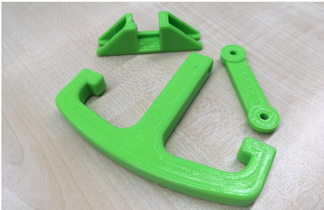
Obrázek 47 – Příklad vytisknutého předmětu po vyhlazení acetonovými výpari – zdroj: autor
