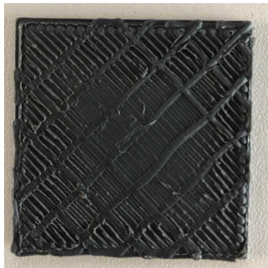
Obrázek 59 – Příliš mnoho vytlačeného materiálu – zdroj: Mikelo [47]
