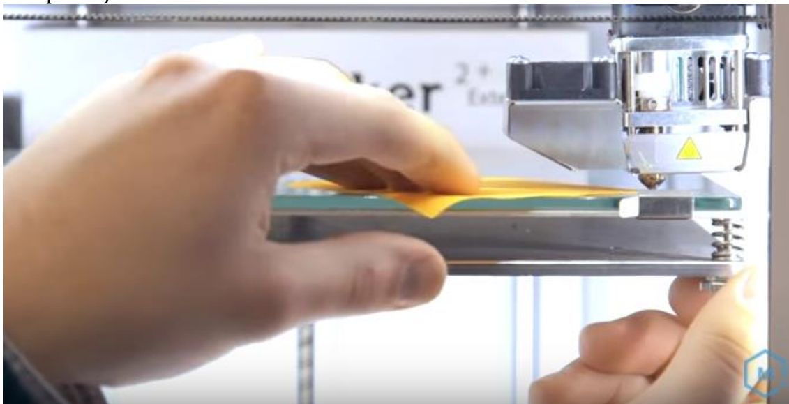
Obrázek 41 – Nastavení výšky trysky od tiskové plochy – zdroj: Alec Richter – MatterHackers [34]
