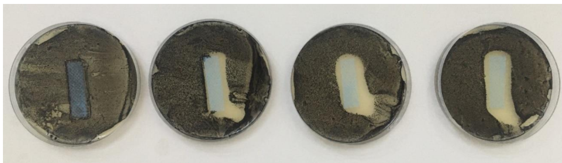
Obrázek 31 Porovnání všech testovaných materiálů o plošné hmotnosti 10 g/m 2 a o velikosti 10 x 40 mm, na kterých byly sledovány halo zóny Petriho misce na agaru Braid Parker v inokulum Staphylococcus gallinarum .
