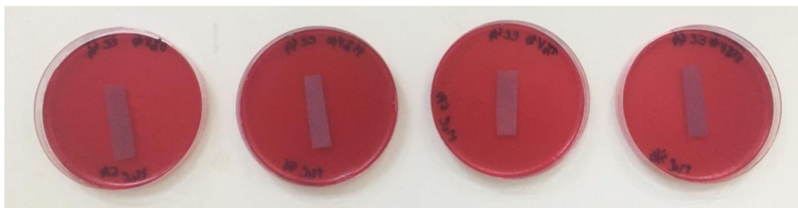
Obrázek 28 Porovnání všech testovaných materiálů o plošné hmotnosti 10 g/m 2 a o velikosti 10 x 40 mm, na kterých byly sledovány halo zóny Petriho misce na agaru Nutrient v inokulum Escherichia Coli .
