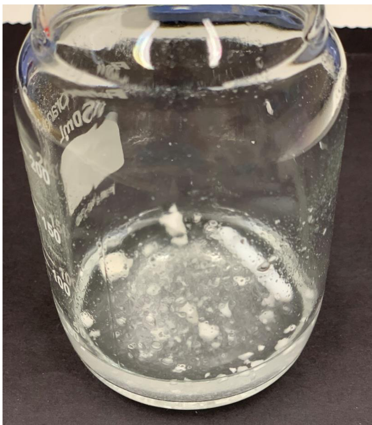
Obrázek 18 Příprava polymerního roztoku, kdy byl Vankomycin vložen do celého rozpouštědlového systému a nešel rozptýlit.
