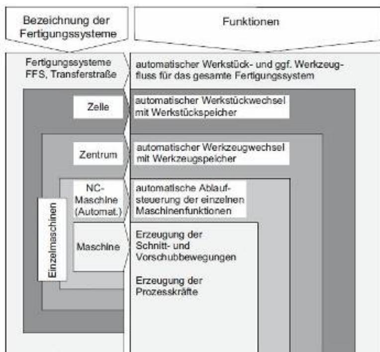
Abbildung 2.1 Bezeichnung der Fertigungssysteme nach dem Automatisierungsgrad [8].
