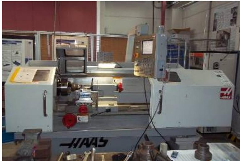
Abbildung 5.2 Drehmaschine HAAS TL2-HE.
