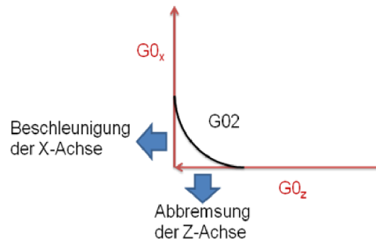
Abbildung 6.3 Kombination vom Eilgang der Z- und der X-Achse durch eine Kreisinterpolation (G02)
