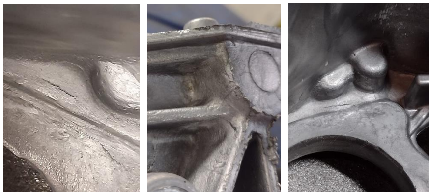
Obr. 37 Praskliny v různých místech odlitku skříně převodovky.
