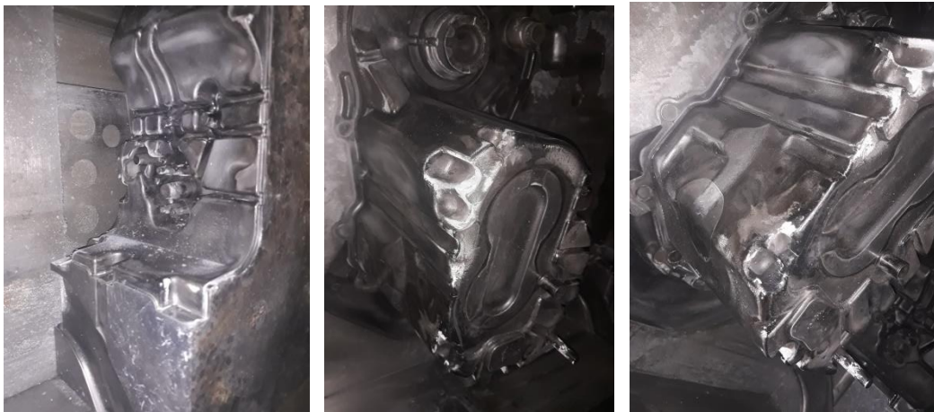
Obr. 35 Ukázky nalepování taveniny na lici formy, vedou ke snížené kvalitě povrchu různých míst odlitků skříně převodovky.
