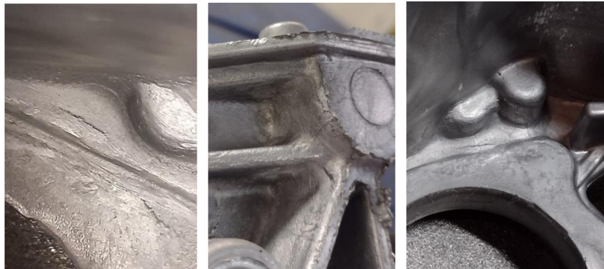
Obr. 37 Praskliny v různých místech odlitku skříně převodovky.
